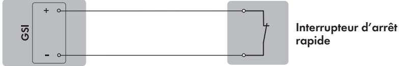
Figure 11 : Raccordement d'un interrupteur d'arrêt rapide à l'entrée numérique GSI du Sunny Boy Smart Energy qui doit être configuré comme System Manager
