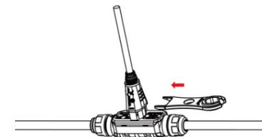
f. Connectez le câble CC du module au câble CC du micro-onduleur.
