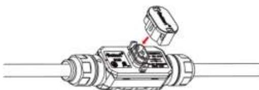
*\*Remarque:* dans les cas où il est nécessaire de retirer le câble CA de l'onduleur du port de bus, utilisez l'outil de déverrouillage du connecteur CA et insérez l'outil sur le côté du port CA.
