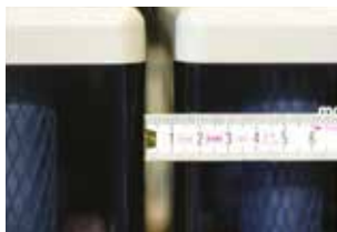
Fig. 5-13: écart de 10 mm entre les éléments de batterie
