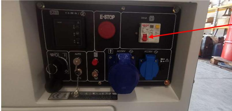
Le disjoncteur doit être abaissé et la clef présente sur le contact
