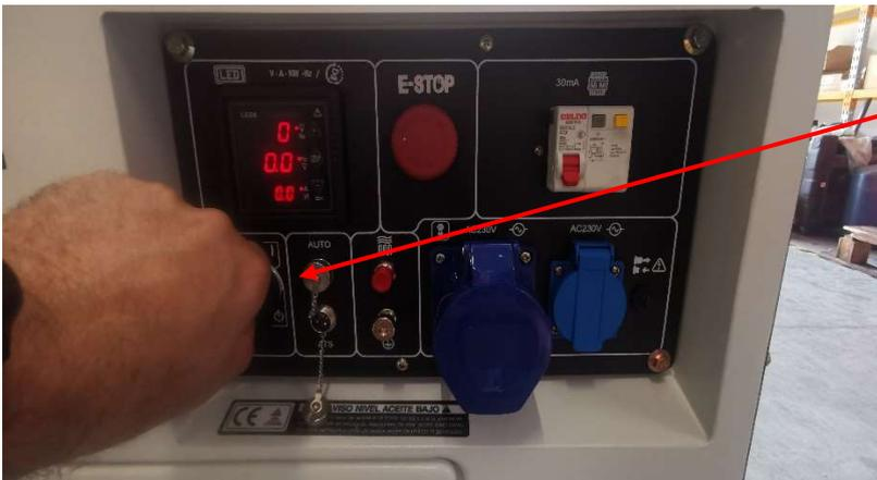
Tourner la clef de contact et démarrez le groupe électrogène
