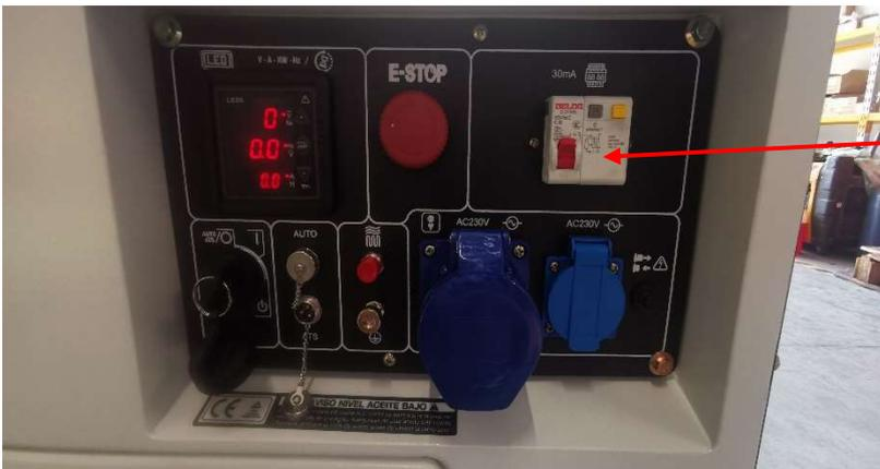
Laisser tourner le moteur pendant 2 minutes environ et enclencher le disjoncteur pour que le groupe délivre la tension
