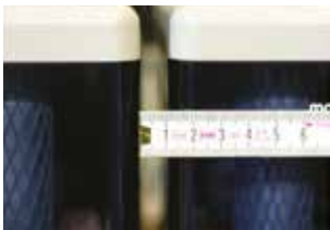
Abb. 5-13: 10 mm Abstand zwischen den Batteriezellen
